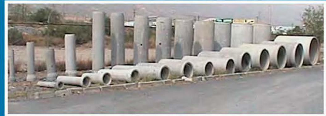
*Tubería de Concreto (Simple y Reforzada)*
